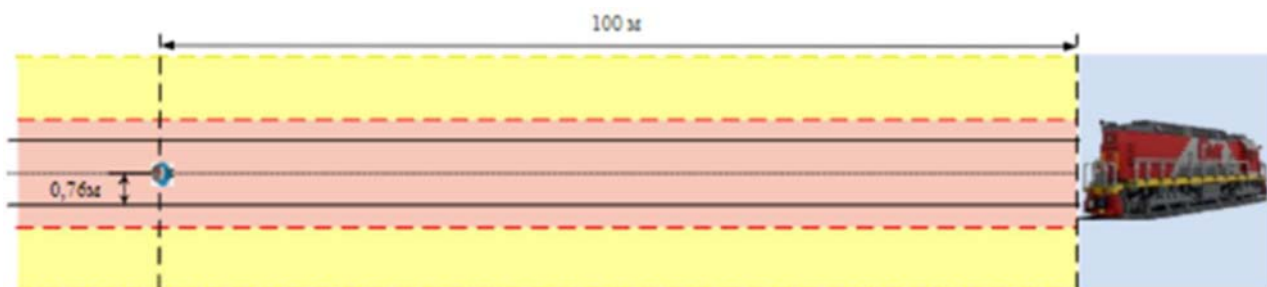
Рисунок 20 – Схема размещения препятствия «Взрослый человек» в красной зоне
