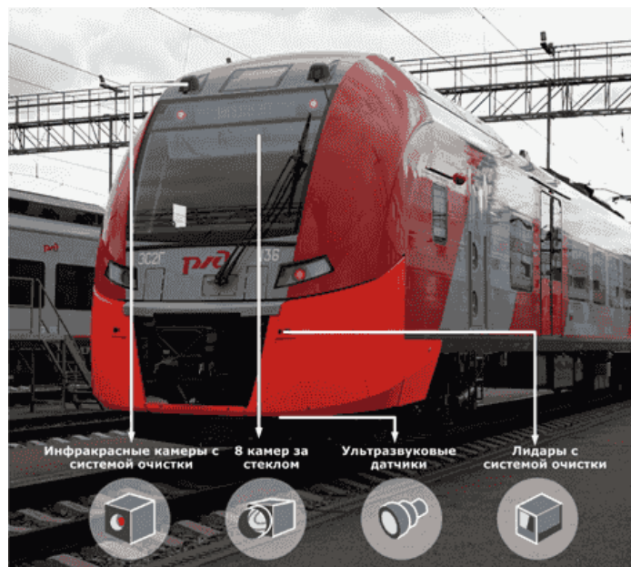
Рисунок 3. Система технического зрения для БОП на ЭС2Г-136
