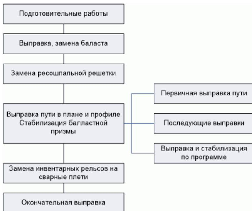
**Рисунок 1.** Структурная схема технологии реконструкции верхнего строения пути и капитального ремонта
