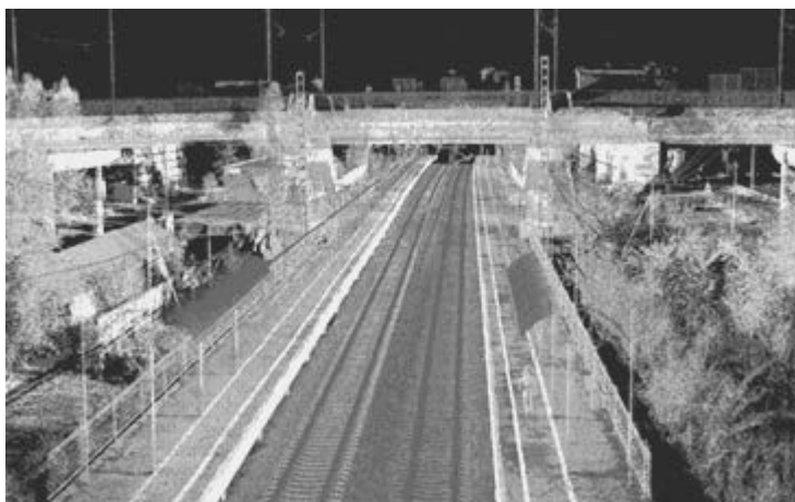
Рисунок 3. Модель точек лазерных отражений в местной железнодорожной системе координат
