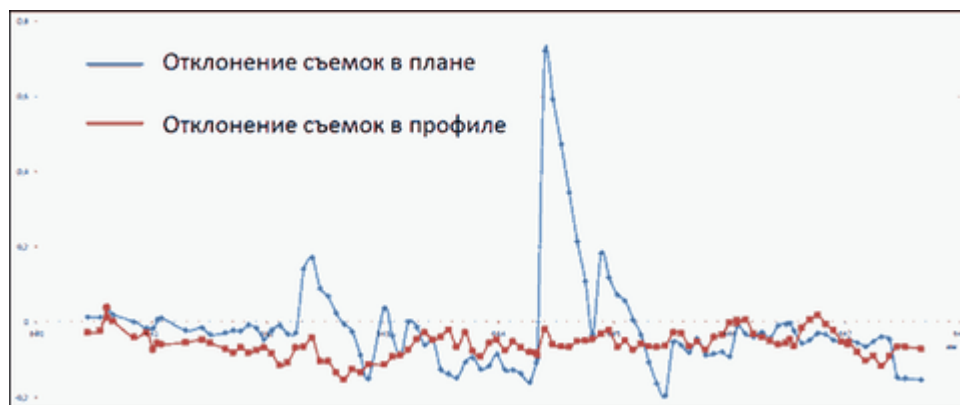
Рисунок 12. Отклонение измерений, выполненных комплексом АГМ-МС7.2100 и традиционной инструментальной съемкой в плане и по высоте .
