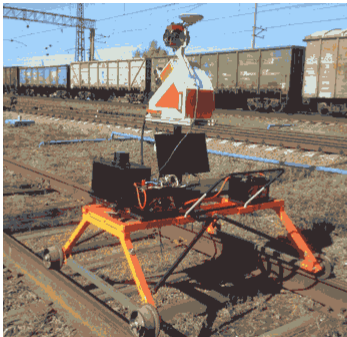
Рисунок 11. Общий вид тележки с установленным сканирующим комплексом.
