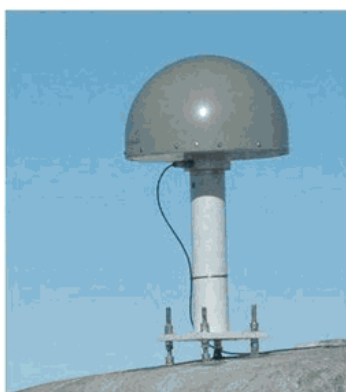
Рисунок 2. Конструкция базового центра типа «пилон».
