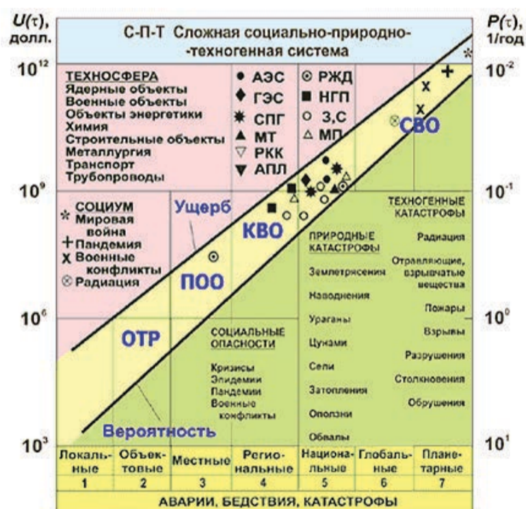
Рисунок 1. Категорирование опасных процессов и объектов С-П-Т системы по характеристикам ущербов, вероятностей и рисков
