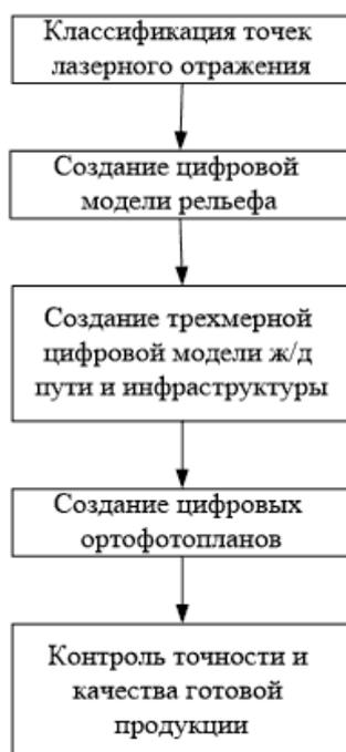
Рисунок 3. Технология геоинформационного моделирования с использованием МЛС.
