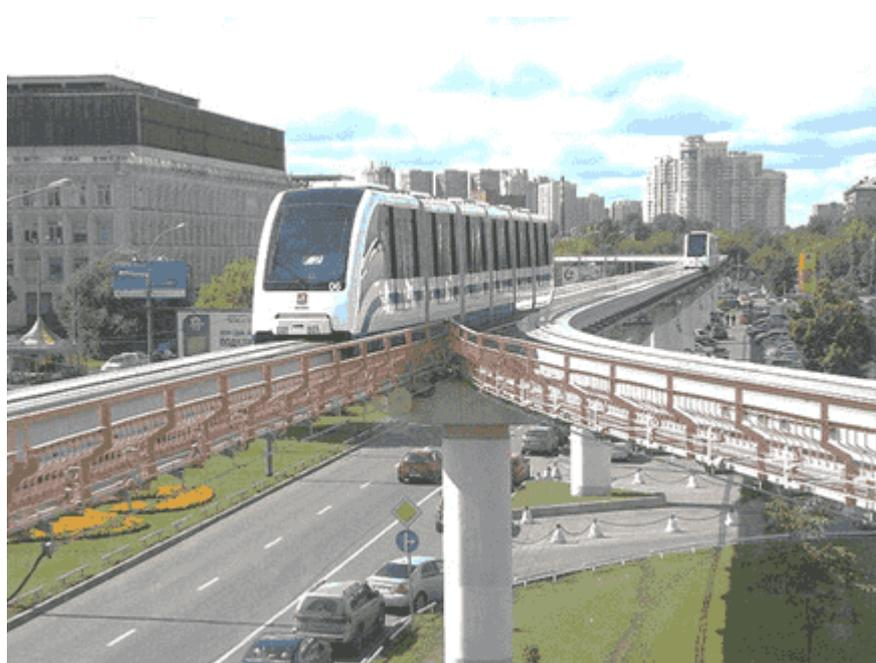
Рисунок 1. Московский монорельс – первая в мире монорельсовая система с линейным двигателем.
