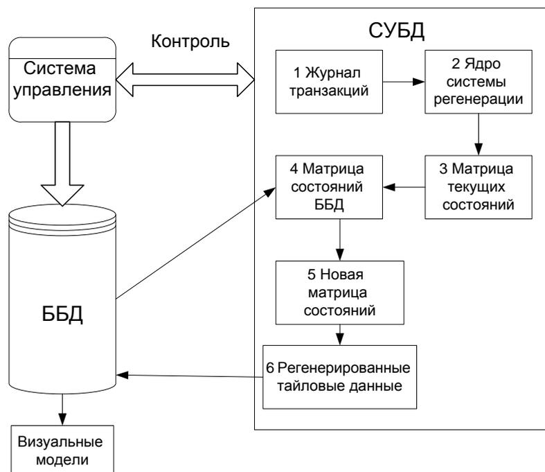
Рисунок 2. Алгоритм автоматизированной регенерации БД
