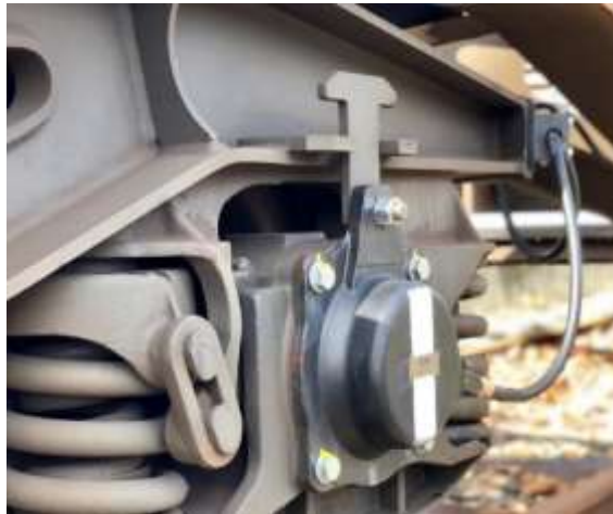
Рисунок 3. Размещение датчиков для контроля состояния транспортного средства.
