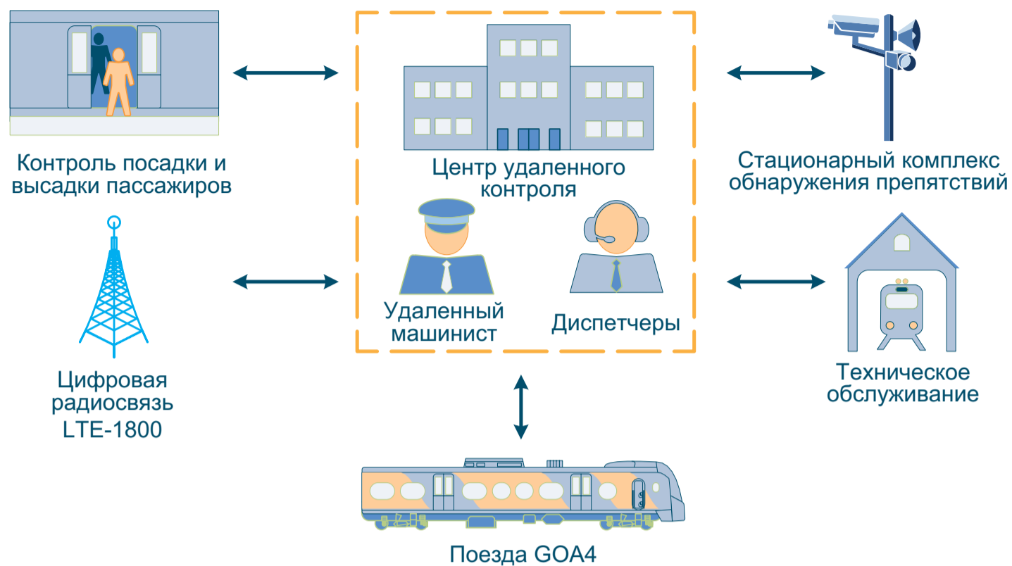
Рисунок 4. Архитектура беспилотной системы управления на МЦК
