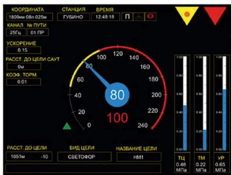
Рис. 1. Эскиз лицевой панели блока индикации
