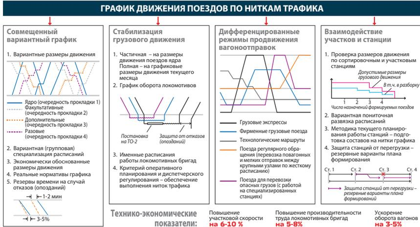
Рис.7. Гармонизация грузового движения и работы станций
