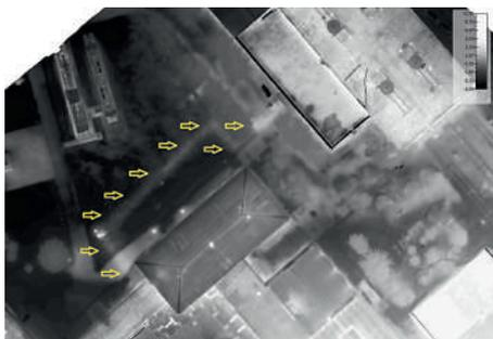
Рис. 6. Фрагмент ортофотоплана, построенный по данным с камеры теплового диапазона DJI Zenmuse XT2 котельной и тепловых сетей на территории ТЧэ-6 Буй с выделенной подземной теплотрассой (высота съемки 100 м)
