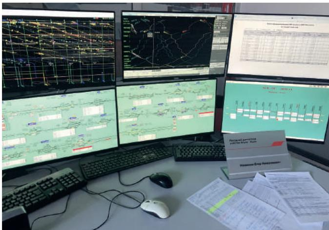
Рис. 2. Рабочее место поездного диспетчера с АРМ ИСУЖТ
