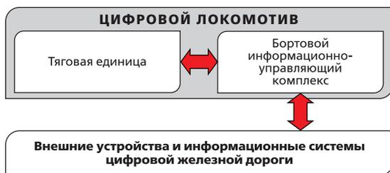
Рис. 6. Структурная схема «цифрового локомотива»
