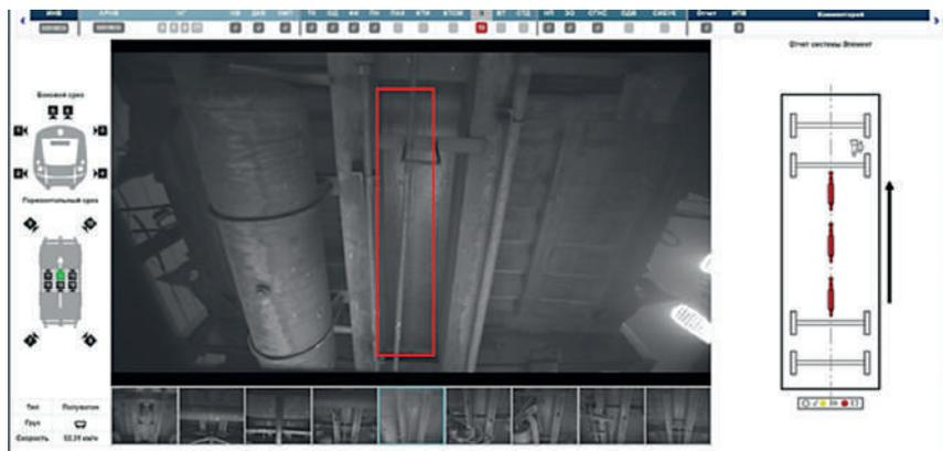
Рис. 4. Информационно-диагностический интерфейс системы «Элемент» при работе в составе ППСС
