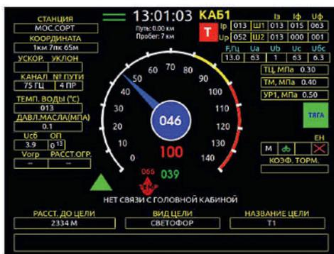
Рис. 6. Эскиз лицевой панели блока индикации единой системы управления движением
