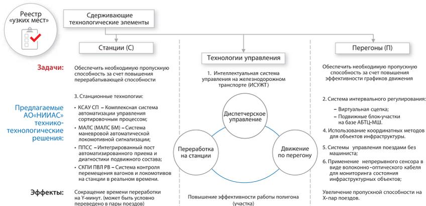
Рис. 1. Принципиальная схема увеличения провозной способности
