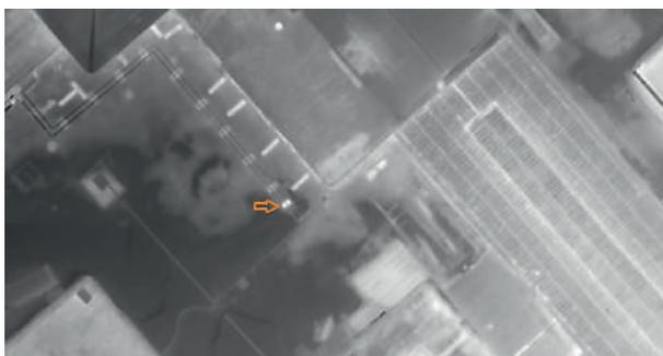
Рис. 8. Фрагмент ортофотоплана, построенный по данным с камеры теплового диапазона DJI Zenmuse XT2 котельной и тепловых сетей на территории ТЧЭ-6 Буй с выделенным местом утечки тепла из надземной теплотрассы (высота съемки 100 м)
