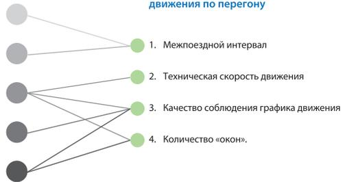
Рис. 6. Ключевые технологические компоненты перегонов
