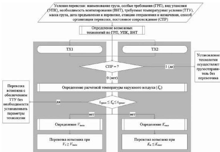
Рис. 3. Блок-схема выбора технологии перевозки и установления ее параметров на железнодорожной части НХЦ
