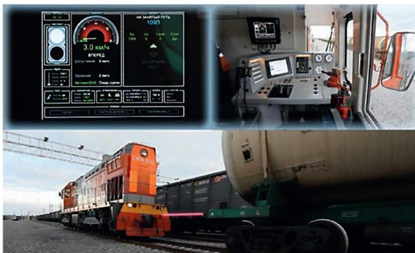
Рис. 5. Тепловоз ТЭМ7А №542 оборудованный бортовой аппаратурой МАИС, работающий в режиме без участия машиниста
