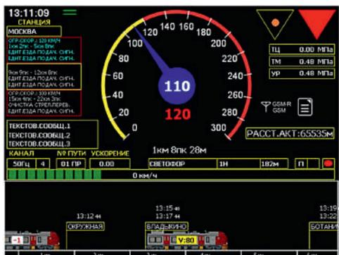
Рис. 4. Человеко-машинный интерфейс комплекса БЛОК на МЦК
