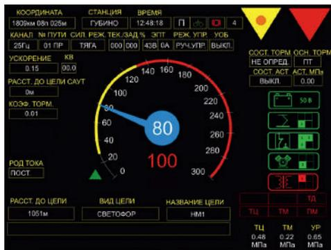
Рис. 5. Эскиз лицевой панели блока индикации при отображении функции взаимного резервирования информации
