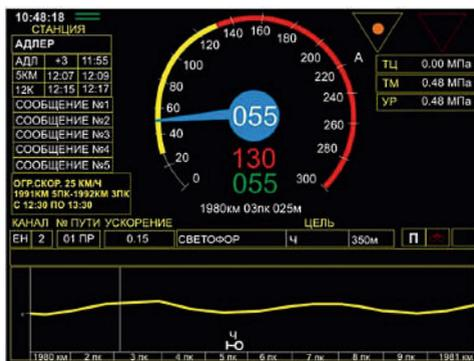
Рис. 2. Эскиз лицевой панели блока индикации с профилем пути
