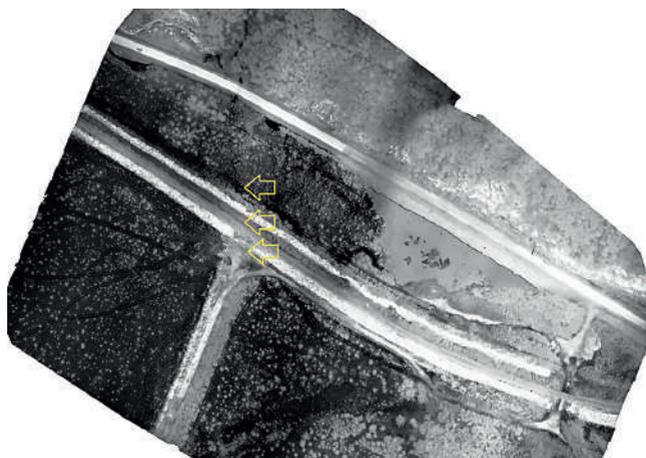
Рис. 21. Растепление земляного полотна вследствие транзита влаги под насыпью в районе 187 км ПК 2 линии Тында – Беркамит
