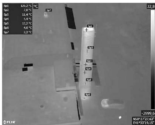
Рис. 9. Изображение с камеры теплового диапазона DJI Zenmuse XT2 трубы котельной железнодорожной больницы ст. Буй (высота съемки 45 м)
