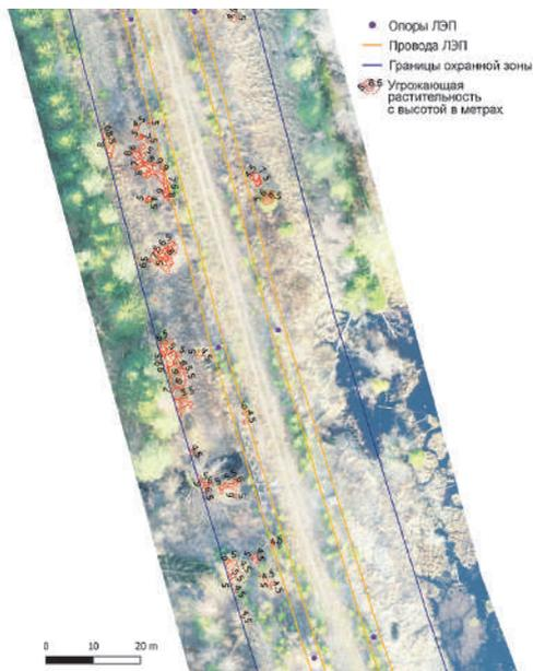
Рис. 5. Участок фидерной линии с выделенной древесной растительностью, превышающей безопасную высоту
