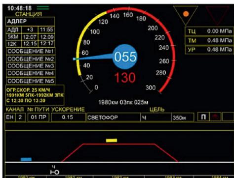
Рис. 3. Эскиз лицевой панели блока индикации с двухпутной вставкой
