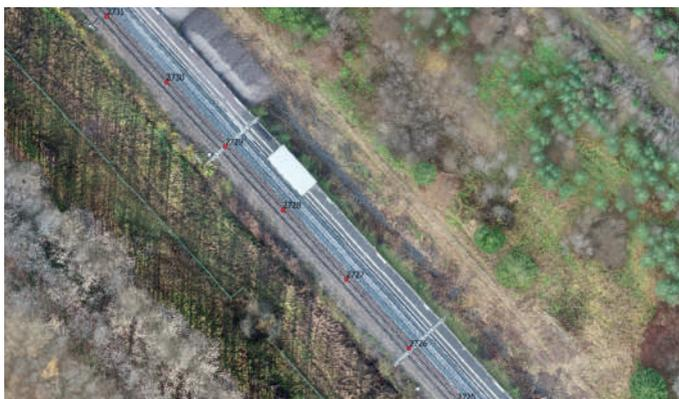
Рис. 1. Ортофотоплан с нанесенными отметками середины головки левого рельса первого пути
