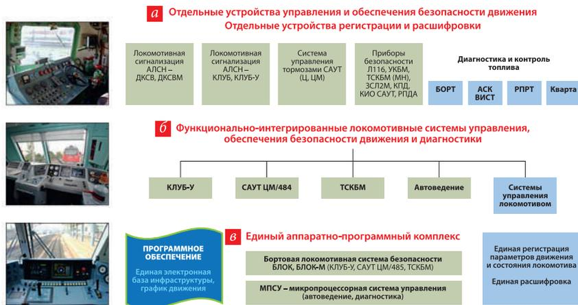
Рис. 1. Интеграция систем и устройств безопасности движения
