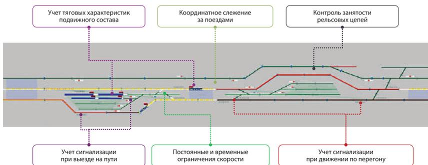
Рис. 6. Схема микромоделирования движения поездов на МЦК
