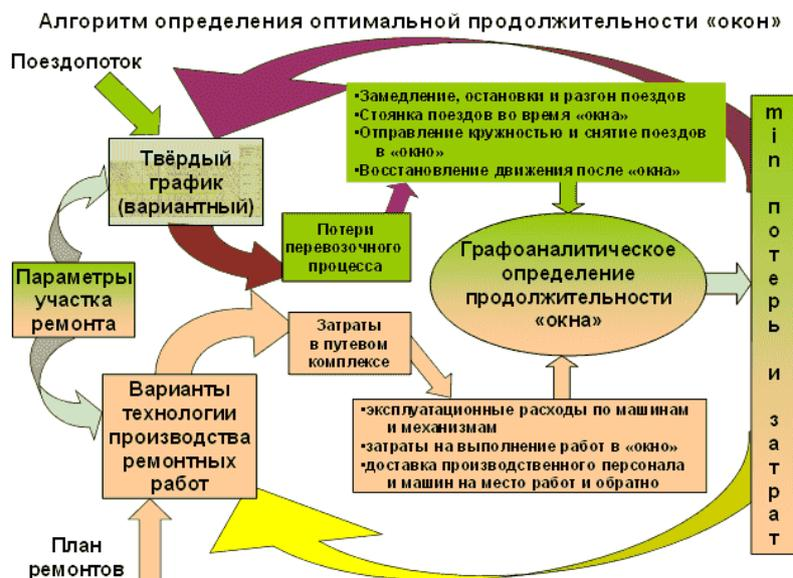
Рисунок 1. Алгоритм определения оптимальной продолжительности «окна»
