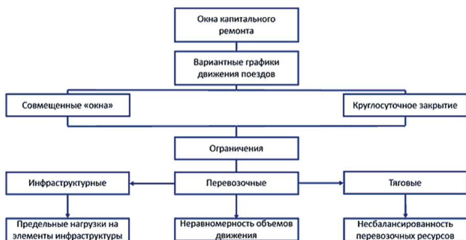
Рисунок 2. Схема ограничений при организации ремонтно-путевых работ
