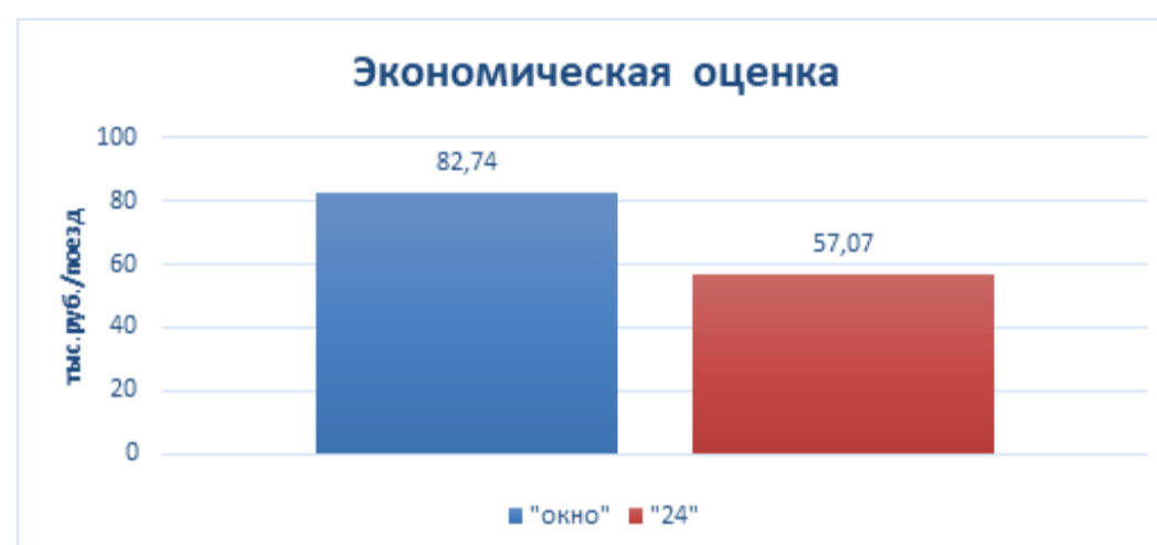
Рисунок 3. Сравнение вариантов организации движения в период ремонтно-путевых работ
