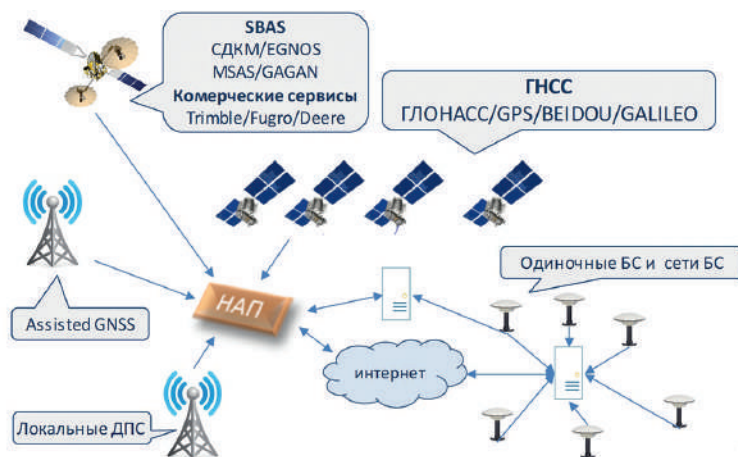
Рис. 1. Режимы высокоточных навигационных определений НАП ГНСС
