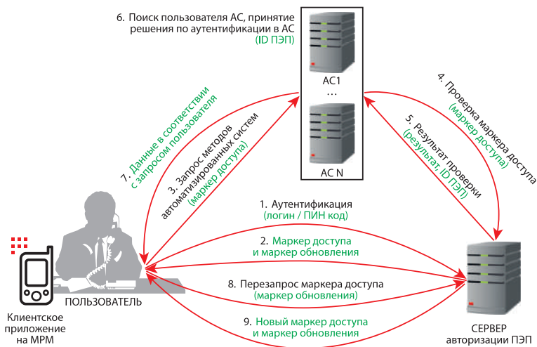
Рис. 1. Алгоритм аутентификации с использованием ПЭП
