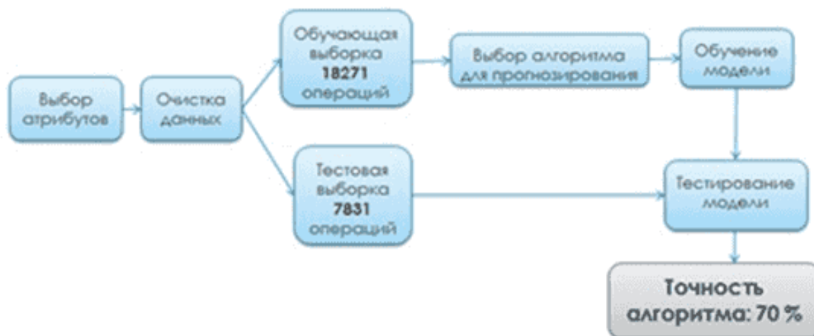
Рисунок 13 - Определение математической модели для прогнозирования предотказных состояний локомотивов
