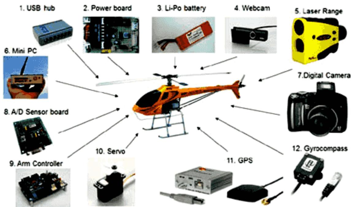
Рисунок 7. Аппаратное обеспечение БПЛА [280].
