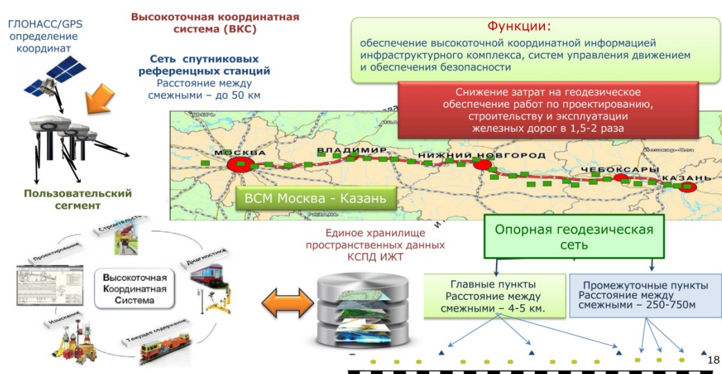
Рис. 12. Построение единого координатно-временного пространства ЦЖД с использованием ГЛОНАСС и геоинформационных технологий
