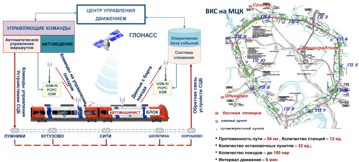
Рис. 9. Опыт внедрения комплексной системы управления движением на МЦК
