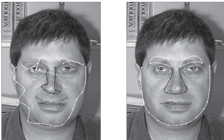
Рис. 2. Профильная оптимизация без сглаживания контура (слева) и с применением сглаживания (справа)
