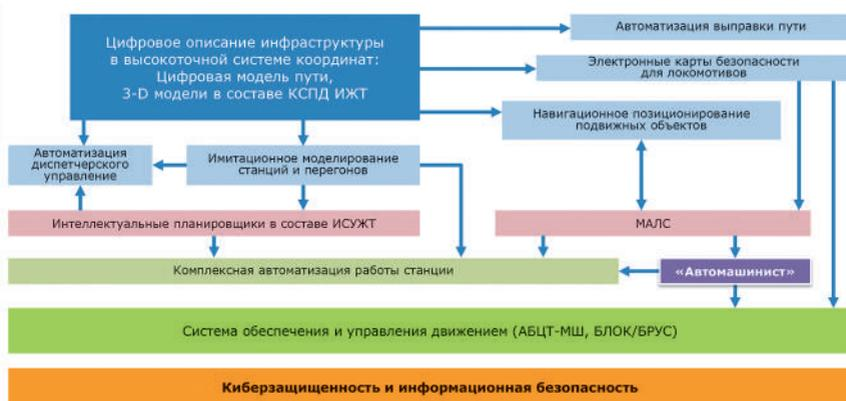
Рис. 7. Технологическое наполнение автоматизированного комплекса управления и обеспечения безопасности движения поездов на МЦК.
