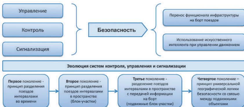
Рис. 3. Эволюционный переход к новому поколению систем контроля, управления и сигнализации при создании автоматизированного комплекса управления и обеспечения безопасности движения на МЦК.
