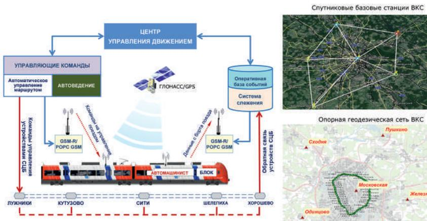
Рис. 17. Пример построения и использования высокоточной координатной системы (ВКС) на МЦК
