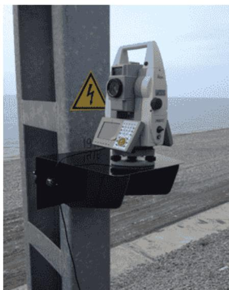
**Рис. 6.** Способ крепления тахеометра при проведении измерений
