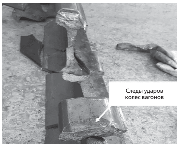
Рисунок 1. Фрагменты разрушения рельса при сходе вагонов
