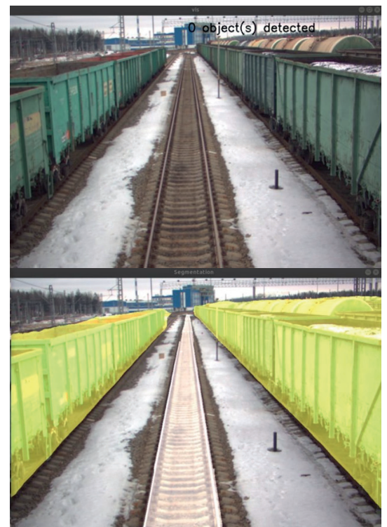
Рис. 3. Пример семантической сегментации колеи и вагонов
