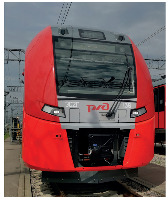
Рис. 2. Электропоезд ЭС2Г «Ласточка» с сенсорами технического зрения
