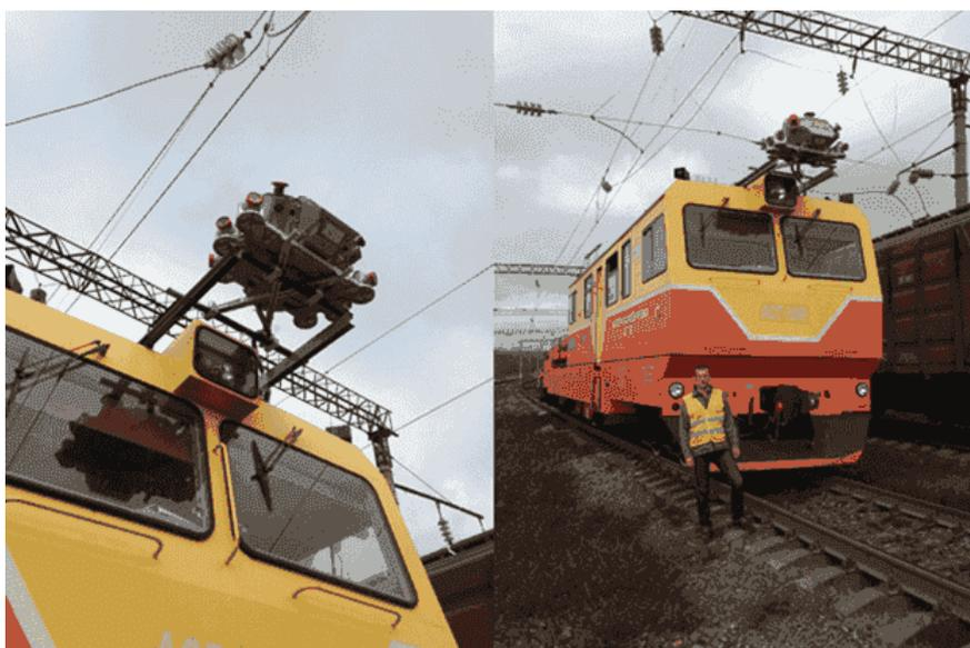
**Рисунок 1.** Система мобильного сканирования RIEGL VMX-450, установленная на крыше автотрисы АСГ-30П
