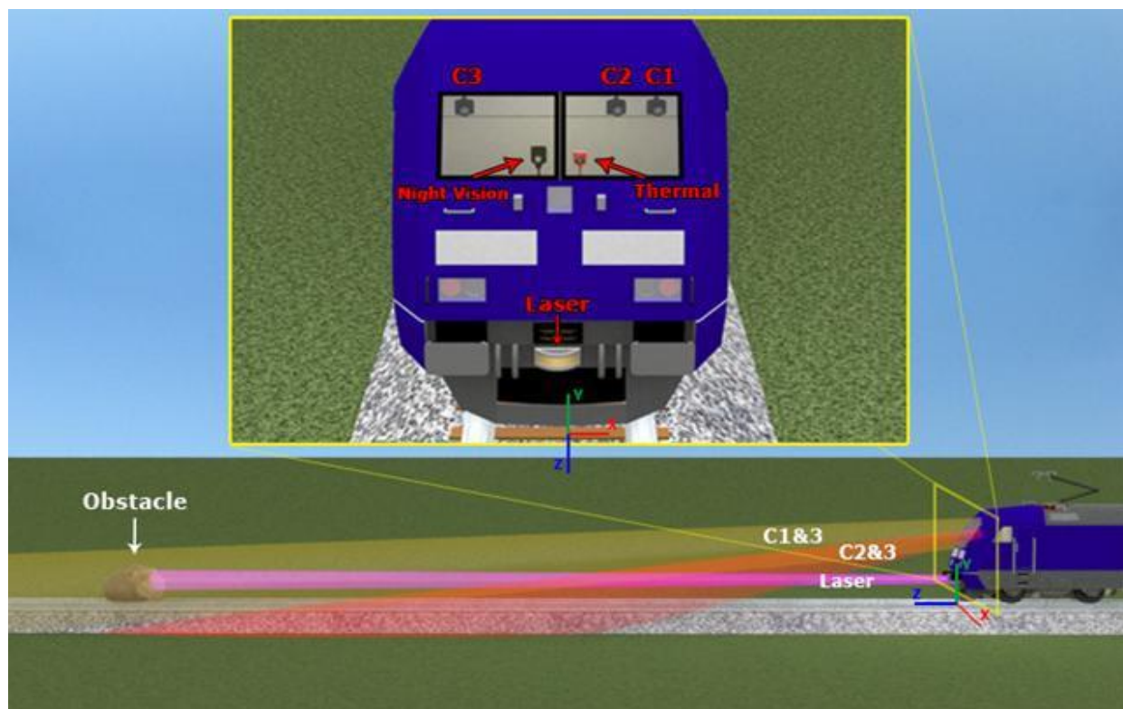
Рисунок 1. Вверху: расположение датчиков СТЗ на локомотиве вид спереди; внизу: вид датчиков со схемой обнаружения препятствий
