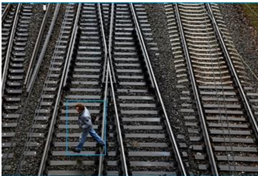
Рисунок 2. Фиксация стационарной СТЗ появления человека в запрещенной зоне
