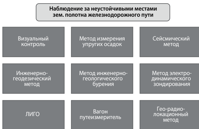
Рис.2. Методы контроля, применяемые при наблюдении за неустойчивыми местами земляного полотна.
