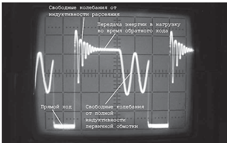
Рис.1. Искажения импульса обратногоходового преобразователя
